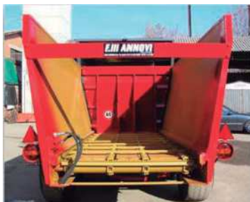
LADO TRASERO MOVIL CON AVANCE AUTOMÁTICO, ACCIONADO POR CADENAS, PARA PRODUCTOS SEMIDENSOS
