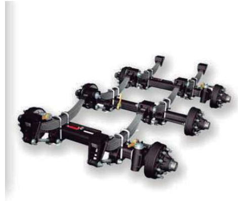
TRIDEM COM SUSPENSIÓN DE 1 ° Y 3 ° EJES AUTOMÁTICOS Y BLOQUEO HIDRÁULICO
