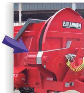
RODILLO LATERAL ELEVADO QUE GARANTIZA DERRAMAR 1 METRO MÁS ALLÁ DE LAS RUEDAS
